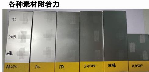
实验条件: 80°C加烤8h, 进行加烤密着确认及后续进行水煮测试,
